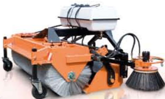
Подметально-уборочная машина AGATA ZM-1600 с оросителем и боковой щёткой
