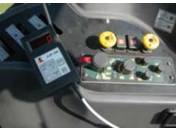
Панель управления прессом, расположенная в кабине трактора, облегчает работу оператора
