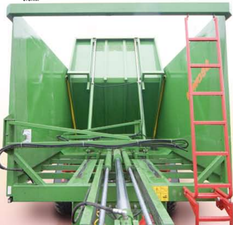
Гидравлическая система передвижения и подъема стенки
