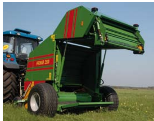
Пресс-подборщик Z500 – разгрузочный столик ускоряет сбор материала
