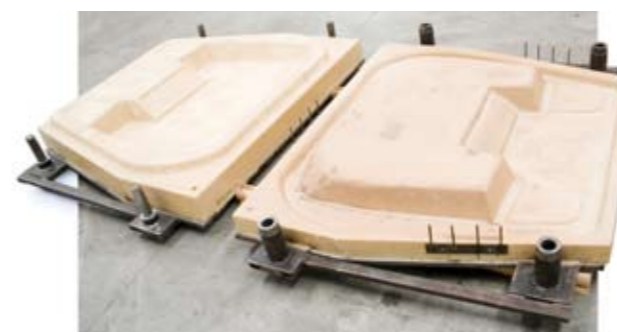
Две половинки формы обшивки, подготовленные для производства элементов под пресс-формованием
