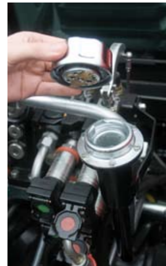
Легкий доступ к пробке маслоналивной горловины в значительной степени облегчает техническое обслуживание трактора
