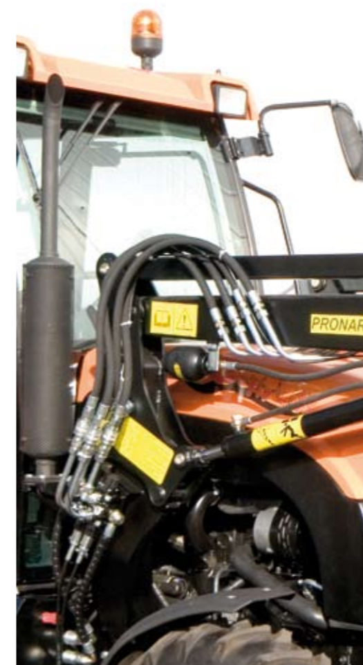
Продуманная конструкция крепления погрузчика не мешает в проведении сервисных работ трактора
