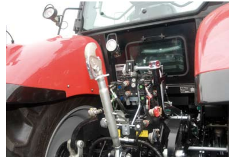
Маслоналивная горловина для трансмиссионного масла в тракторах PRONAR 8140, сконструированного на приводной системе ZF находится в задней части трактора
