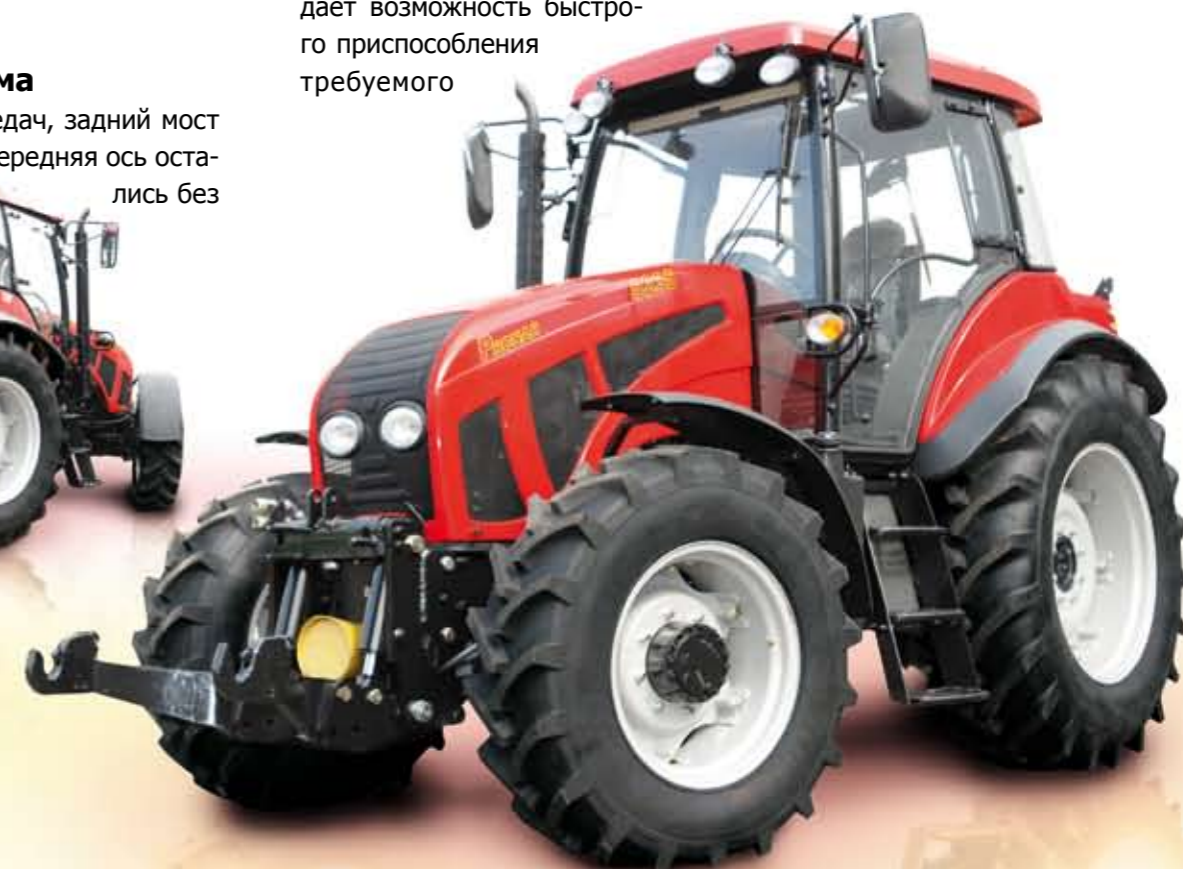
Большой угол поворота передних колес облегчает маневрирование трактором
