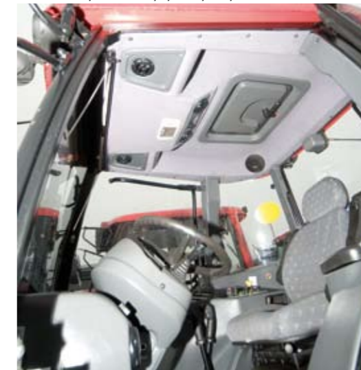
Подшивной потолок замонтирован в тракторе серии PRONAR P5 вместе с добавочными элементами и является эргономически и комфортабельно запроектированным элементом интерьера в кабине
