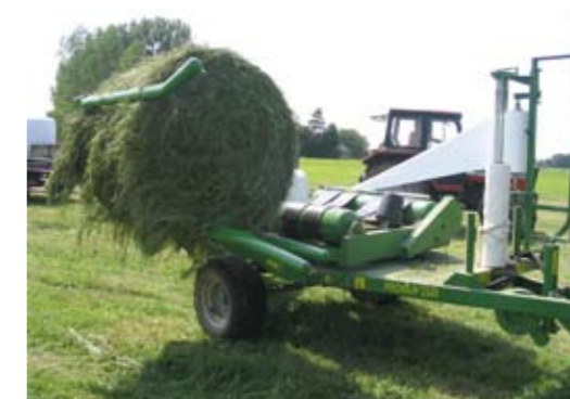
Погрузка тяжелого рулона сенажа не проблема для обмоточной машины Z245
