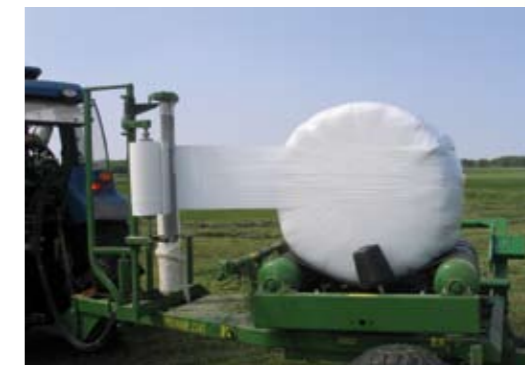
Самозагружающаяся обмоточная машина Z245, так же как ее предшественница Z235 отлично справляется с рулонами диаметром 1,2 м и 1,5 м.
