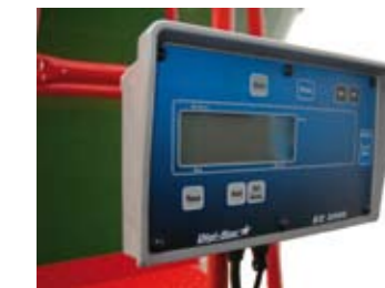
Весы с дисплеем в смесителе-кормораздатчике позволяют установить точную дозировку компонентов корма
