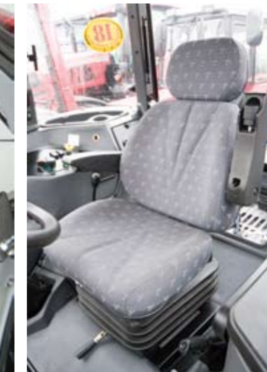
Комплектное сиденье водителя оснащенное в удобные подлокотники с регулицией в полной сфере положения
