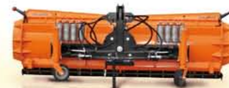
Способ крепления PUV-3300 - трёхточечная система навески TUZ категории II и III
