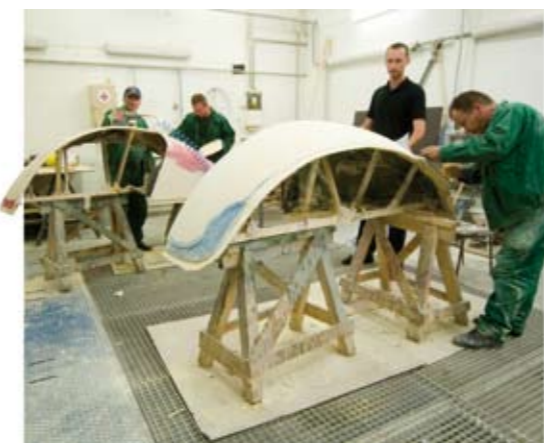
Изготовление модели задних грязевиков тракторов PRONAR P6 и P9 для создания производственной формы
