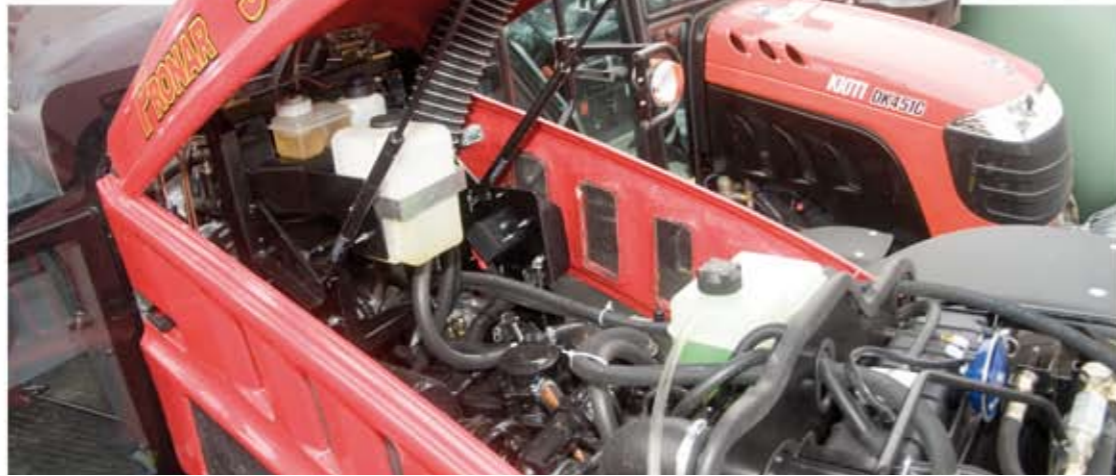
Уравнительные бачки для охлаждающей жидкости (передняя часть двигателя), тормозной жидкости и жидкости для омывателей (задняя часть двигателя) в тракторе PRONAR 5135 доступны после поднятия капота
