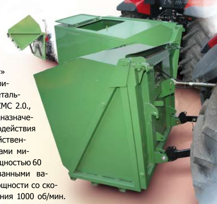
Самозагруженный контейнер (грузоподъёмность 1000 кг, вместительность 1,5м³) крепится на задней или передней трёхточечной навеске TУЗ трактора или на фронтальном погрузчике
