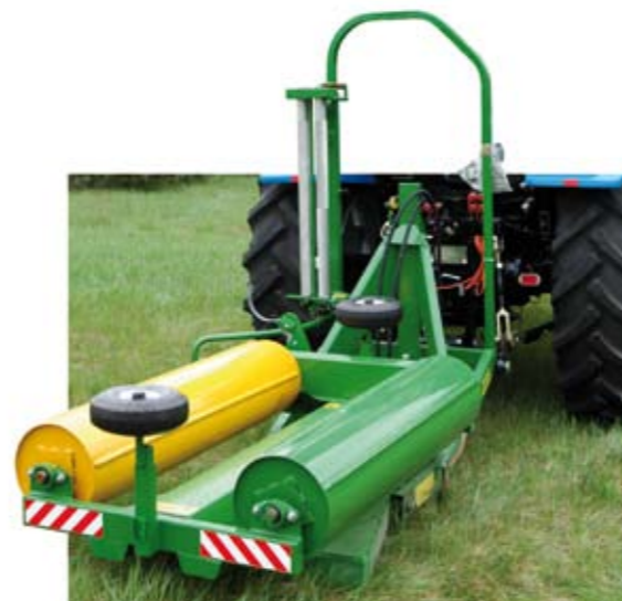
Не большая, но полезная в малых хозяйствах обмоточная машина Z235
